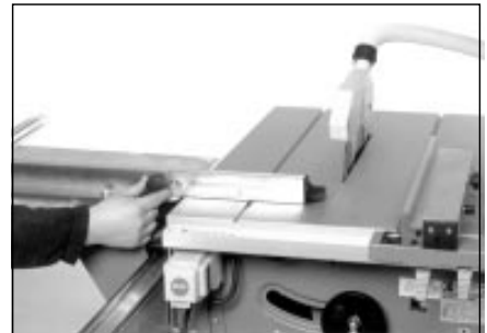
Das Endstück des Winkelanschlagprofils dicht an das Sägeblatt heranschieben und die Sterngriffe festziehen.
